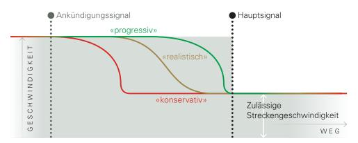
Die «konservative» Fahrweise unterscheidet sich beim Bremsverhalten. Bereits bei einer angekündigten tieferen Geschwindigkeit (Vorsignal) wird unmittelbar auf diese Zielgeschwindigkeit reduziert. Bei Ankündigung eines Halts wird auf eine definierbare Geschwindigkeit (z.B. 40 km/h) reduziert, mit der man sich dann dem Hauptsignal annähert. Mit diesen beiden Extremwerten lässt sich die Bandbreite der Fahrweisen ermitteln.
